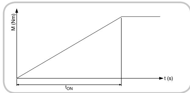
Если регулятор  $MON$ , установлен в ненулевое значение, то при включении УПП напряжение (момент) подаваемое на двигатель быстро возрастет до заданного им значения. Только после этого начинается плавное увеличение напряжения, которое продолжается до достижения напряжения сети питания (100% LED ВКЛ) в течение оставшегося времени запуска. Такой способ запуска позволяет свести износ двигателя к минимуму.
